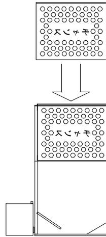
・くじ投入ふたの取っ手を本体側にして上部より下の方向へ挿入して下さい。
